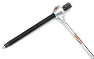
• экстрактор, силовой винт с корпусом
