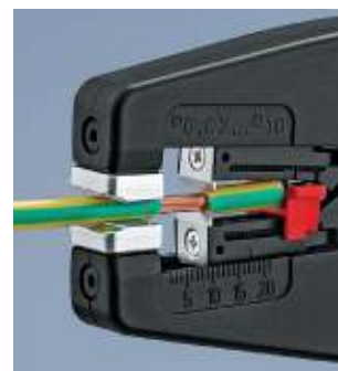
Прецизионное снятие изоляции толщиной от 0,03 до 10,0 мм 2 без последующей юстировки
