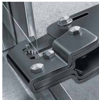
Пуансон инструмента продавливается через профили
