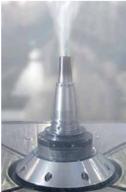
Kühlung bis zur Werkzeugspitze bei 18.000 U/min. Доставка СОЖ к вершине инструмента при 18 000 об/мин.
