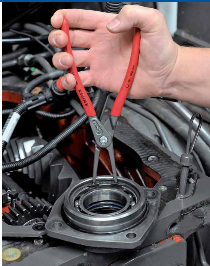
Прецизионные щипцы для стопорных колец для внутренних стопорных колец в отверстиях
