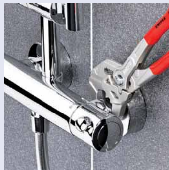
Работы с хромированными деталями без повреждения поверхности
