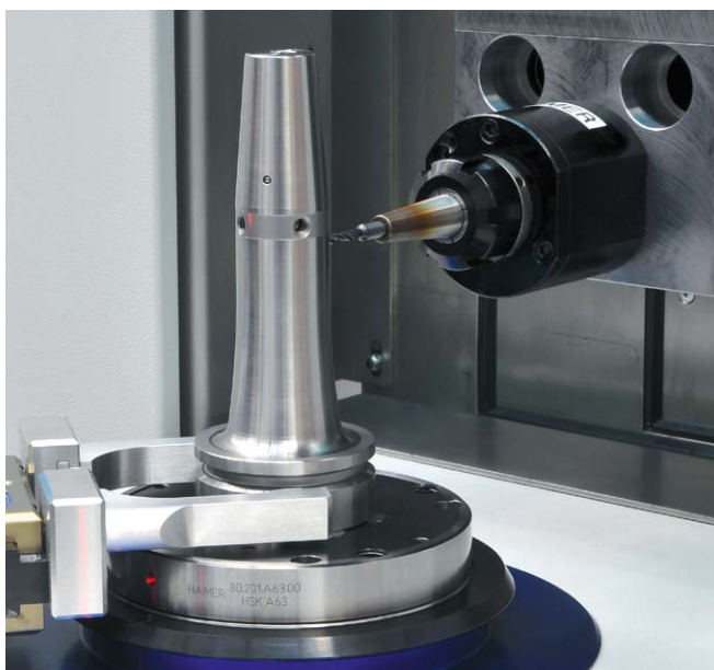
Automatische Beseitigung der Unwucht durch CNC Bearbeitungseinheit Автоматическое удаление дисбаланса при помощи блока чпу
