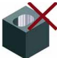
Обработка отверстий со смещением оси
