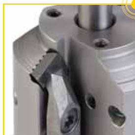
Рифления RIQ определяют конусность седла клапана
