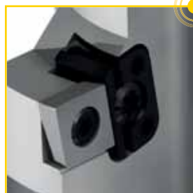
Регулируемое посадочное гнездо
