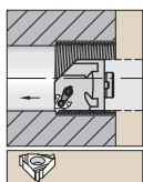
С внутренним подводом СОЖ. Сведения о пластинах см. на стр. E41.
