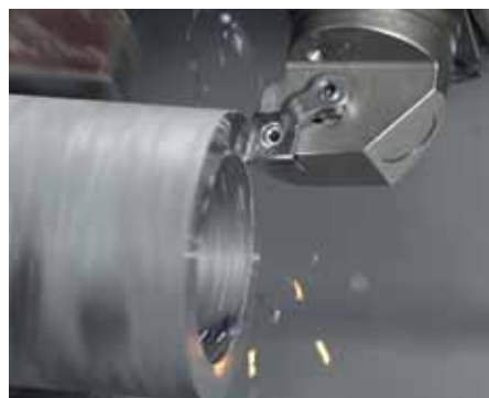
Пластина со стружколомом
