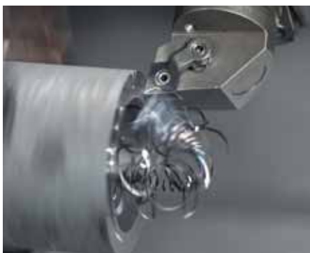
Пластина без стружколома
