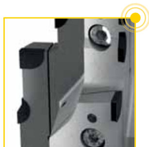
Регулируемое посадочное гнездо под пластину PCD
