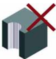
Обработка неполных отверстий
