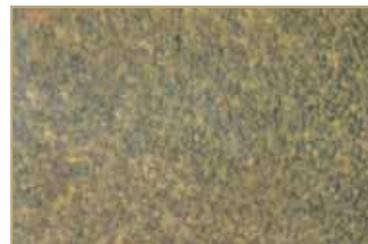
Мелкозернистый сплав (2000 x)
