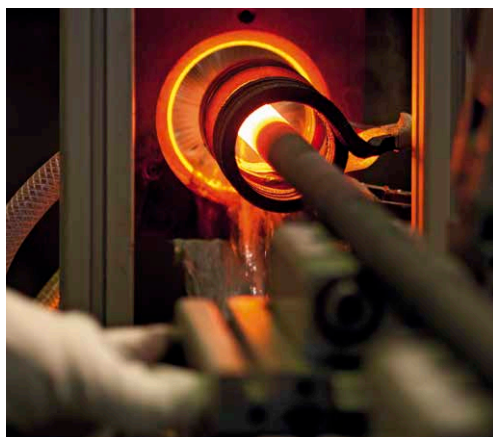
Induktives Härten der Meißel Inductive tempering
