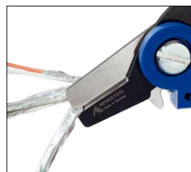
Schneiden der Paarschirmung Cutting the double shielding
