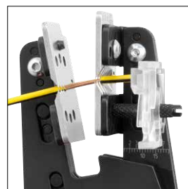
Abisolieren durch Formmesser Stripping with profile blades
